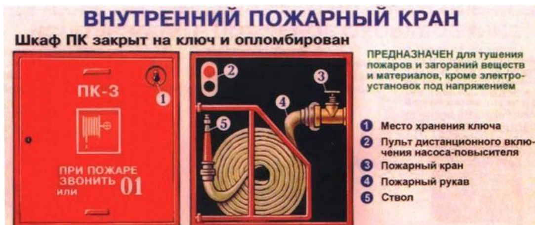
Рисунок 3 – Внутренний пожарный кран
